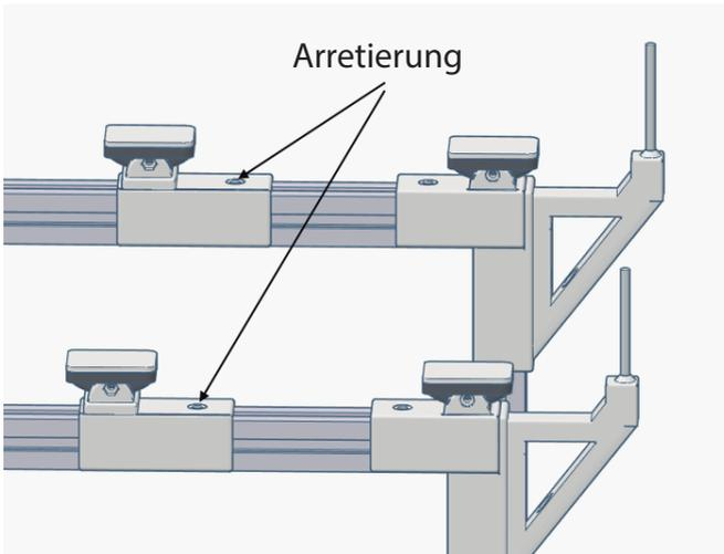
Wenn Sie während der Verwendung der GliderCG Scale den Abstand der Stützen variieren möchten, um zwischen verschiedenen Modellen zu wechseln, müssen Sie das Gerät, wie unten beschrieben, tariieren, sobald der Abstand abgeändert wurde.
